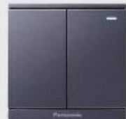
WMF514MYH-VN ★ Công tắc C, 2 chiều, 2 thiết bị, bắt vít, có chỉ báo dạ quang 10AX 250V~
