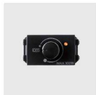
WEG57813B-1-G ★ Bộ điều chỉnh sáng tối (Đèn sợi đốt và đèn Halogen) công suất thấp với biến áp 12V) 300W 220V~ Dây cứng lõi đơn và nhiều lõi: 1.0mm 2 -2.5mm 2
