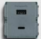
WEF14821MYH-VN Ổ cắm sạc USB 2 cổng chuẩn A và chuẩn C, 5V 3A USB-A: 5V 3A, 9V 2A USB-C (USB PD): 5V 3A, 9V 2A, 12V 1.5A
