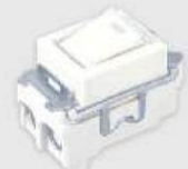
WNG5052W-751 Công tắc C, 2 chiều có đèn báo khi OFF 16AX 250V~
