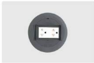
DU81831HTK-1 Ổ cắm âm sàn 2 ổ cắm có dây nối đất và màn che. 16A 250V~
