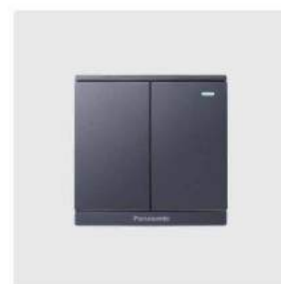
WMF513MYH-1VN ★ Công tắc B, 1 chiều, 2 thiết bị, bắt vít, có chỉ báo dạ quang 10AX 250V~
