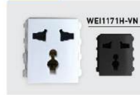
WEI1171SW-VN Ổ cắm đa năng có màn che 16A 250 VAC Dây cứng lõi đơn, dây mềm và nhiều lõi: 1.5-4.0mm 2
