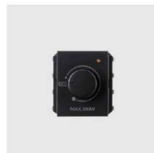
WEG57816B-1-G ★ Bộ điều chỉnh sáng tối (Đèn sợi đốt và đèn Halogen) công suất thấp với biến áp 12V) 500W 220V~ Dây cứng lõi đơn và nhiều lõi: 1.0mm 2 -2.5mm 2
