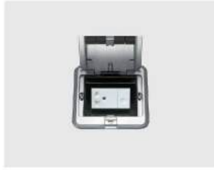
DUF3221LTK-1 Ổ cắm âm sàn với ổ cắm có dây nối đất và màn che bảo vệ 16A 250V~, ổ cắm điện thoại (6P4C), hộp âm và mặt bảo vệ hộp âm.
