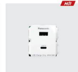
WEF14821W-VN Ổ cắm sạc USB 2 cổng chuẩn A và chuẩn C, 5V 3A USB-A: 5V 3A, 9V 2A USB-C (USB PD): 5V 3A, 9V 2A, 12V 1.5A
